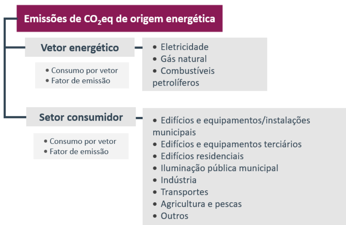
Figura 45 – Representação esquemática da metodologia de cálculo do inventário de emissões de CO 2 eq de origem energética.
