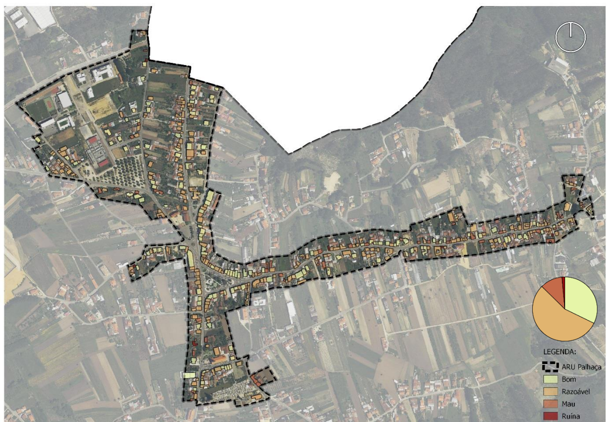
Figura 9 - Estado de conservação do edificado na Área de Reabilitação Urbana da Palhaça
